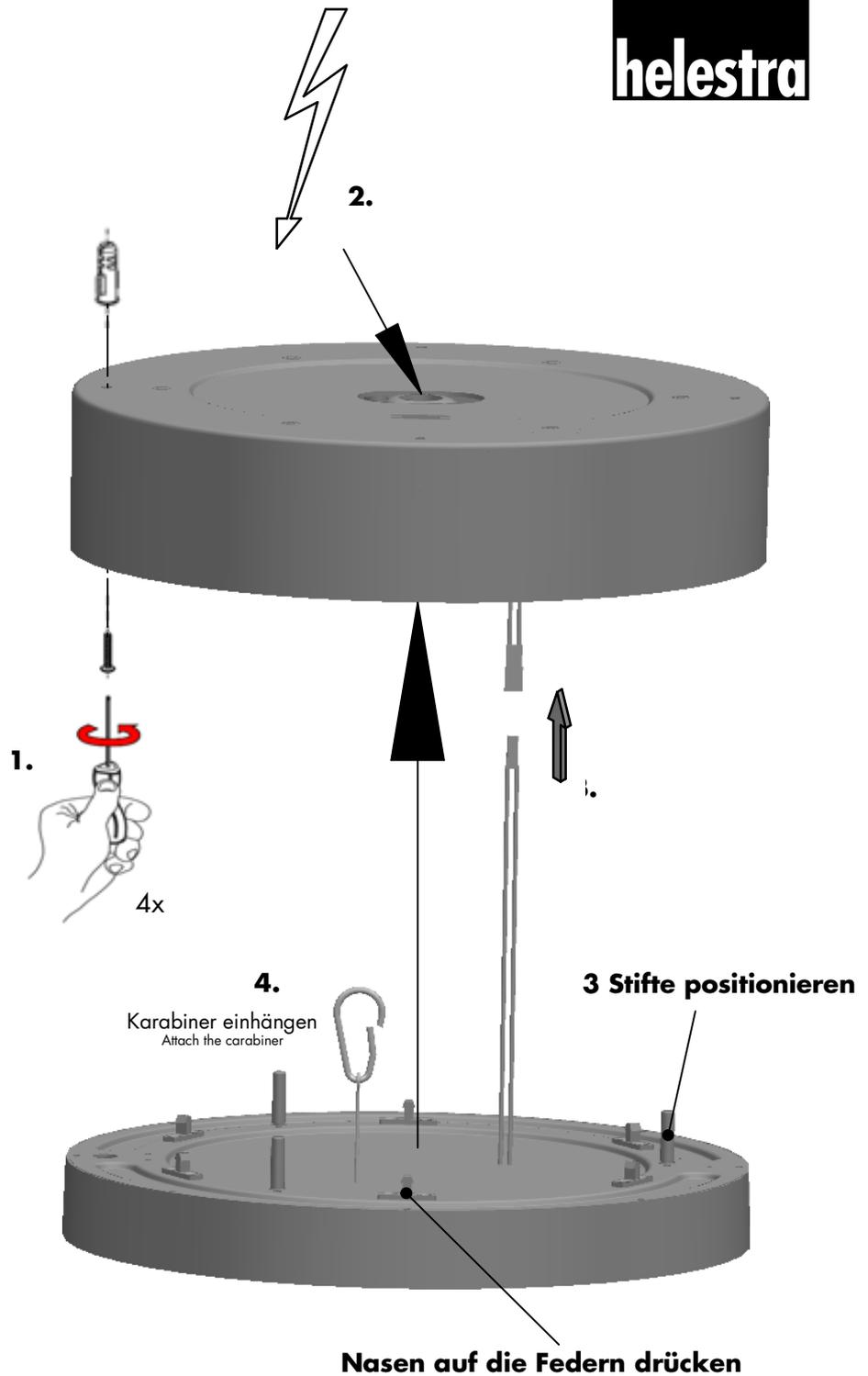
**LED Panel zum Montieren einklicken, zur Demontage LED Panel eindrücken, um die Federn zu lösen.**
